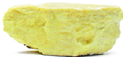
Рис. 7. Сера, произведенная на линии очистки газа PT Krakatau POSCO
