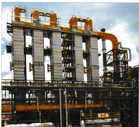
Рис. 3. Холодильники первичного охлаждения газа
